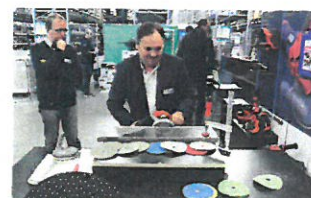
P1-Staubfrei-Schleifsystem zum Schleifen von Naturstein und Keramik »ohne Staubbelastung für Mensch und Umwelt«, entwickelt und patentiert von der Firma Jöst, im Bild GF Peter Jöst. Fotos: B. Holländer (o.), J. König (Detail)
